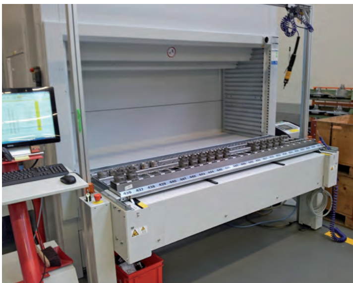
» Avec 494 emplacements, le stockeur rotatif assure la gestion de 32 références produit et des seuils de réassort pour les produits courants.
