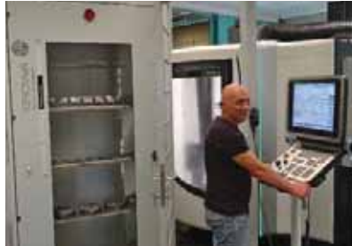
Avec le robot Erowa, Thierry Sciauvaud dispose de 60 heures d'autonomie pour une production à haute valeur ajoutée.
