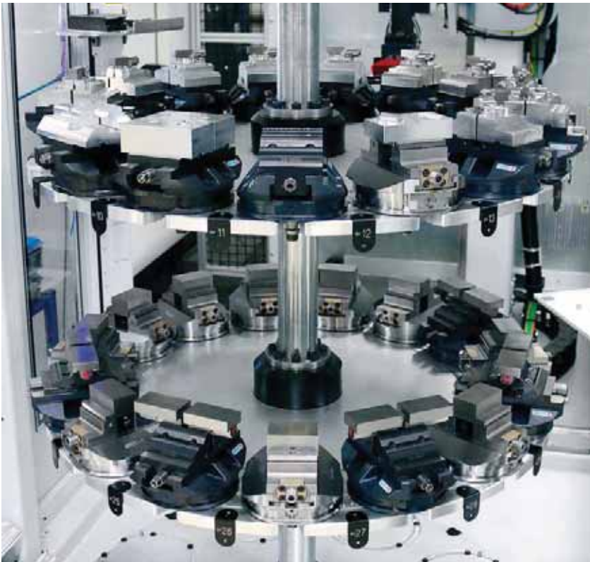
Intérieur du magasin robotisé, des plateaux remplis de mandrins PowerChuck210.
