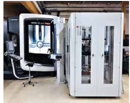
La cellule DMU60-RobotMulti Erowa.
